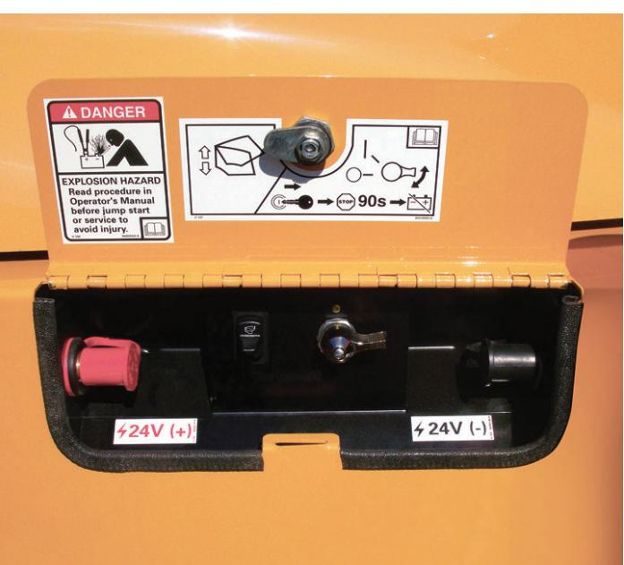
Переключатели открывания капота и аккумулятора. При разряде аккумулятора капот может быть открыт снаружи путем подключения к внешнему источнику
