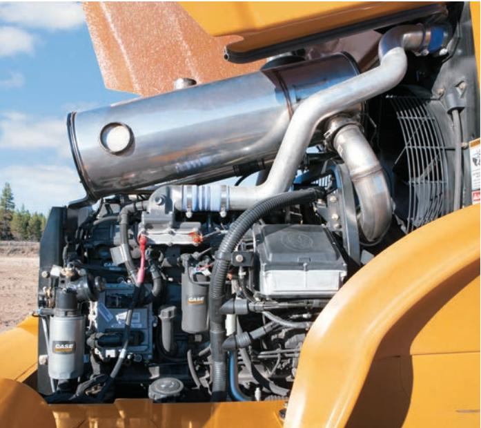
Компоненты под капотом расположены оптимально, что в результате упрощает обслуживание.
