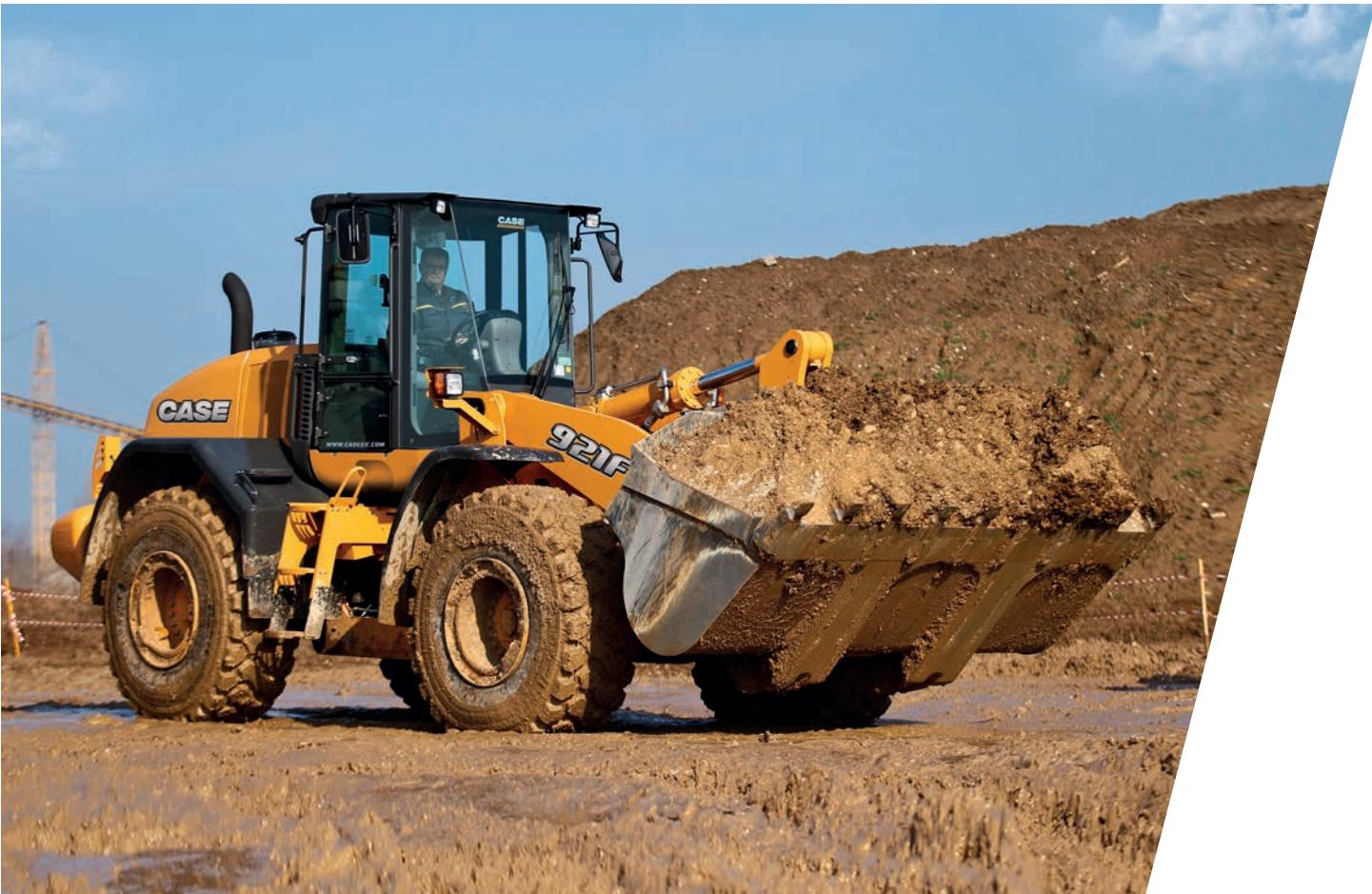
С шинами L5, которые нужны для работы в очень абразивных условиях, мы рекомендуем усиленные мосты. Могут применяться также твердые шины.
