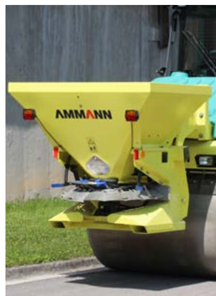
Подготовка для установки универсального щебнеобразователя
