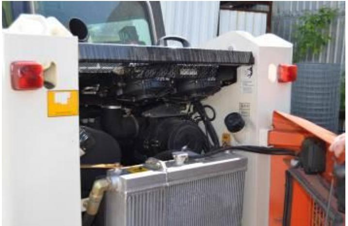
Согласно европейским требованиям, запуск двигателя возможна даже при  $-50^{\circ}\text{C}$ . Во-первых, свечи накаливания с таймером для уверенного пуска в холодный период, они включается на 30 секунд при повороте ключа зажигания в обратную сторону. Во-вторых, есть возможность установки электрического предпускового подогревателя от 220V, так и автономного предпускового подогревателя типа Webasto. Доступ к двигателю простой – откидывается верхняя крышка, компоновка просторная, все под рукой.
