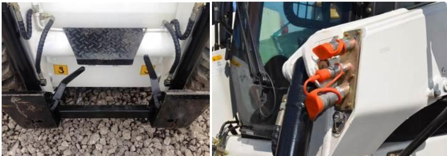
Для увеличения проходимости возможно дооборудование погрузчика [накидными гусеницами](#), а благодаря наличию дополнительных гидролиний возможно использование любого [навесного оборудования](#): [ковш](#), [вилы](#), [мини-экскаватор](#), [щетка подметальная](#), [бетоносмеситель](#), [фреза](#), [гидробур](#), [гидромолот](#), [отвал](#), [снегоочиститель](#), [траншекопатель](#) и много другое.
