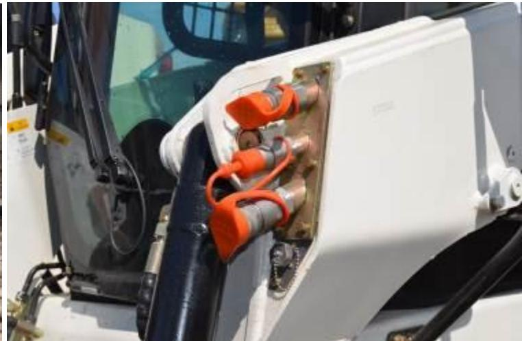
Для увеличения проходимость возможно дооборудование погрузчика [накидными гусеницами](#), а благодаря наличию дополнительных гидролиний возможно использование любого [навесного оборудования: ковш, вилы, мини-экскаватор, щетка подметальная, бетоносмеситель, фреза, гидробур, гидромолот, отвал, снегоочиститель, траншеекопатель](#) и многое другое.
