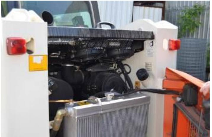
Согласно европейским требованиям, запуск двигателя возможна даже при -50°C. Во-первых, свечи накаливания с таймером для уверенного пуска в холодный период, они включается на 30 секунд при повороте ключа зажигания в обратную сторону. Во-вторых, есть возможность установки электрического предпускового подогревателя от 220V, так и автономного предпускового подогревателя типа Webasto. Доступ к двигателю простой – откидывается верхняя крышка, компоновка просторная, все под рукой.
