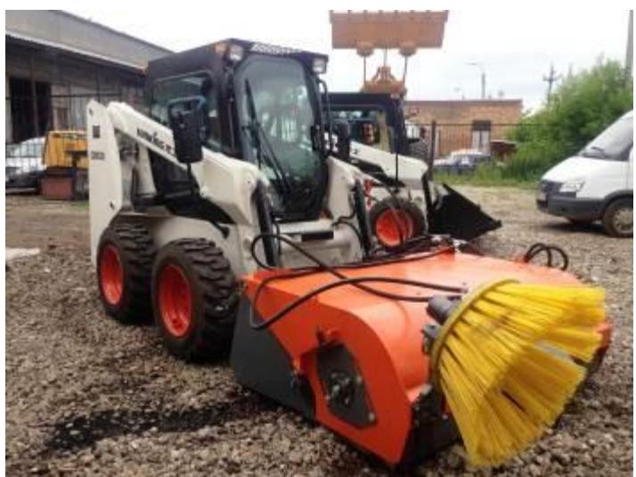
Тем самым по своей расширенной функциональности мини-погрузчики Lonking способны сравниться с целым парком коммунальной техники. Необходимо лишь выбрать соответствующее навесное оборудование. Максимальная высота выгрузки 3060 мм., позволяет использовать Мини погрузчики Lonking для загрузки самосвалов при любой работе.
