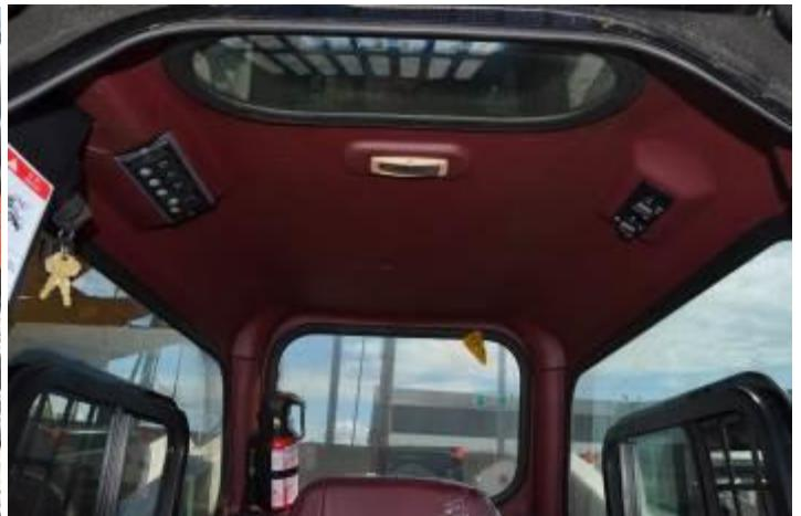
Высокая степень остекления кабины обеспечивают хороший обзор рабочей зоны, а зеркала заднего вида дают возможность обозревать пространство позади машины, дает максимально возможную безопасность при выполнении работ. Высококлассная шумо и вибро изоляция двигателя резко снижает утомляемость оператора, позволяя с легкостью
