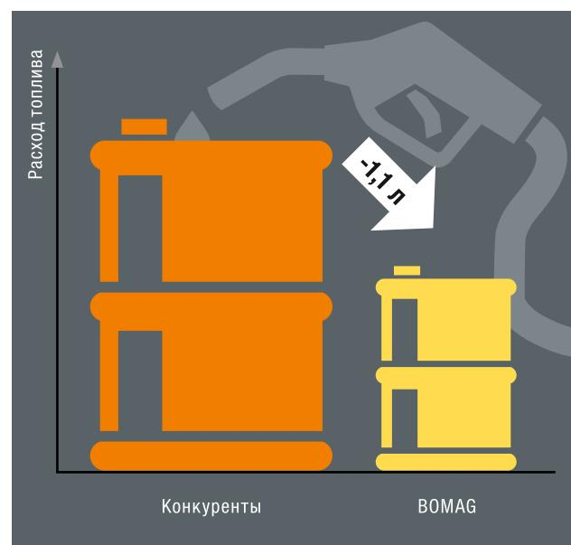
По сравнению с обычными катками с осцилляцией, катки с системой TanGO расходуют на 1,1 л/ч меньше топлива, потому что BOMAG использует законы физики, поэтому дебалансы расположены на максимальном удалении от центра, благодаря чему уменьшаются силы инерции и потребление энергии.
