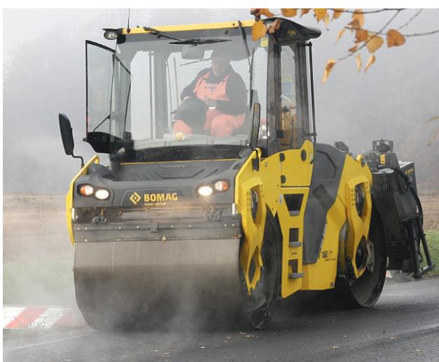
Оснащенный TanGO и щебнераспределителем BOMAG BW 161 ADO реализует широкий спектр применения.
