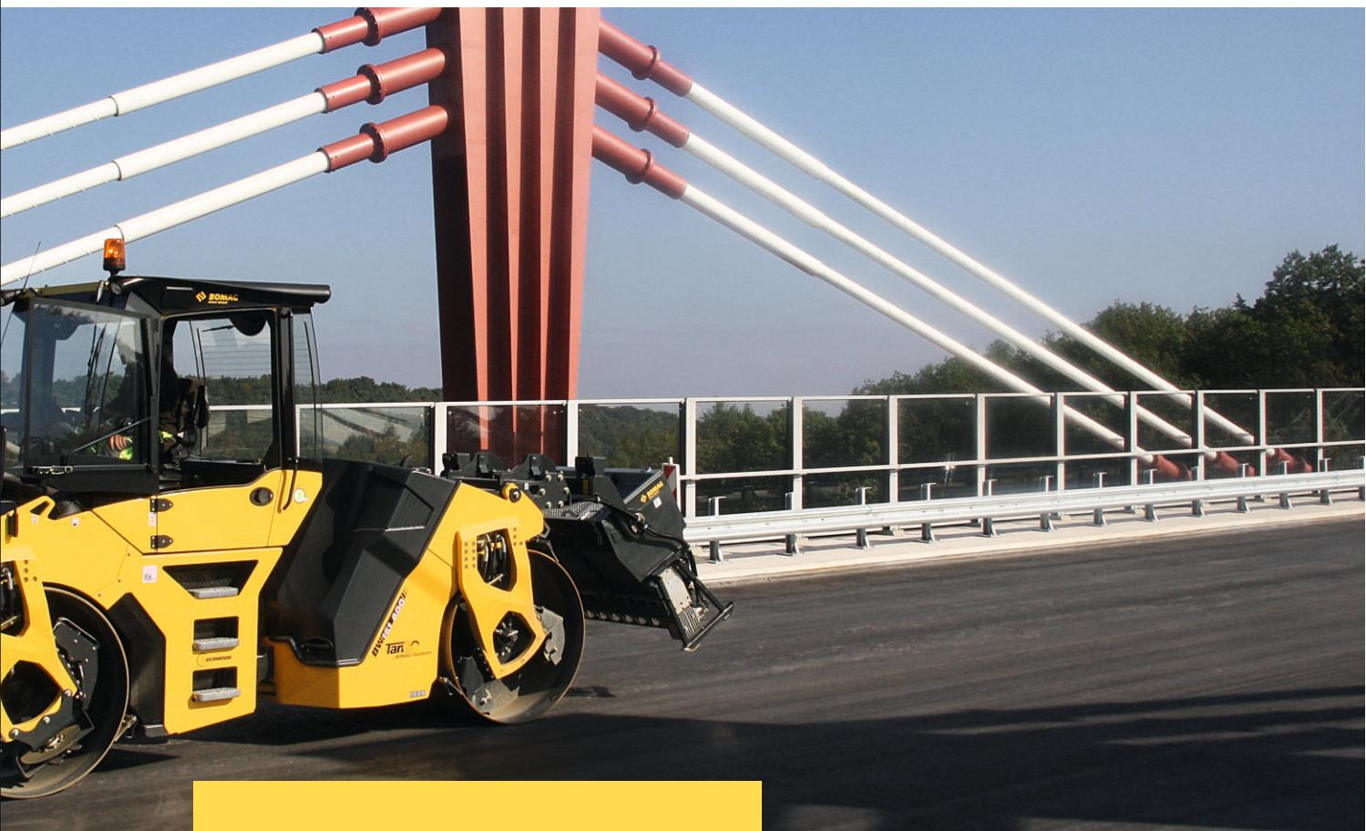
Специалист в области деликатного уплотнения: двухвальцовый каток фирмы BOMAG с осцилляцией TanGO. Деликатное уплотнение на швах и мостах.
