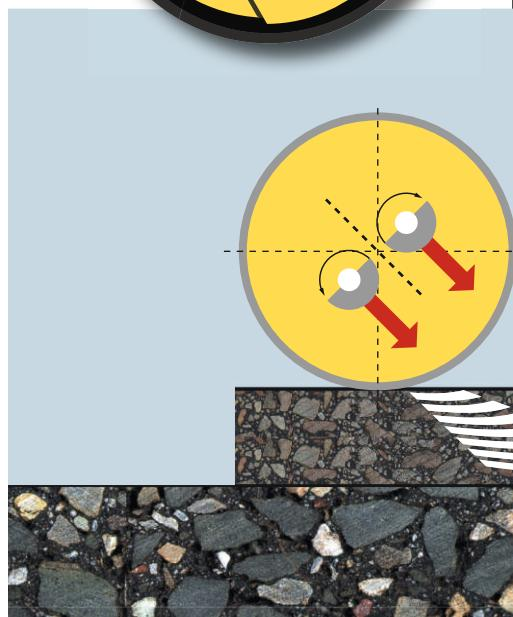
Только у системы ASPHALT MANAGER фирмы BOMAG есть бесступенчато регулируемая и автоматическая амплитуда. Нет более простого и надежного уплотнения. Электронное оборудование измеряет жесткость и выбирает амплитуду в зависимости от покрытия и толщины слоя.
