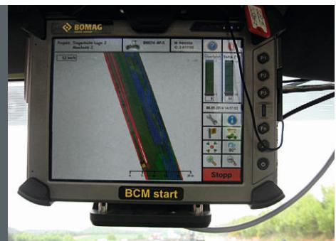
Система BCM net позволяет каждому оператору видеть в реальном времени результаты собственной работы и других операторов, работающих на объекте.
