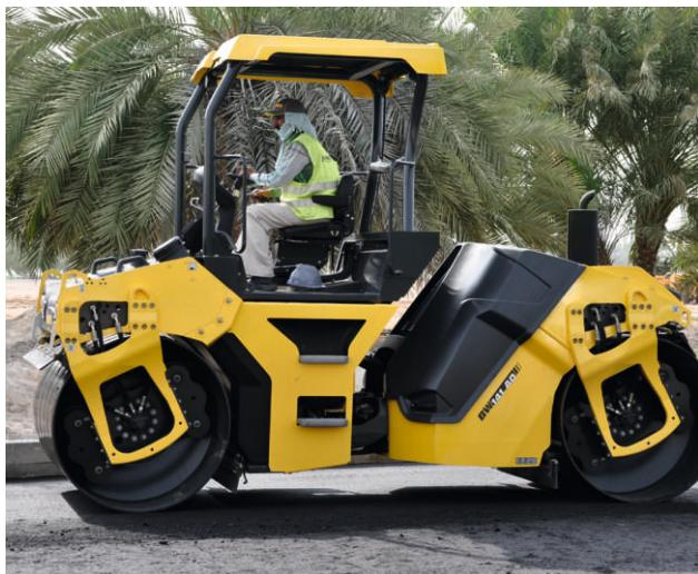
Надежный в работе даже в экстремальных климатических условиях: BOMAG BW 141 AD с двигателем TIER2 в Дубае.
