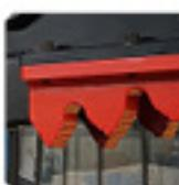
Сменные накладки челюстей имеют дробящие зубья внушительных размеров и изготовлены исключительно из стали Hardox, что позволяет получить максимальное усилие и многолетний срок службы.
