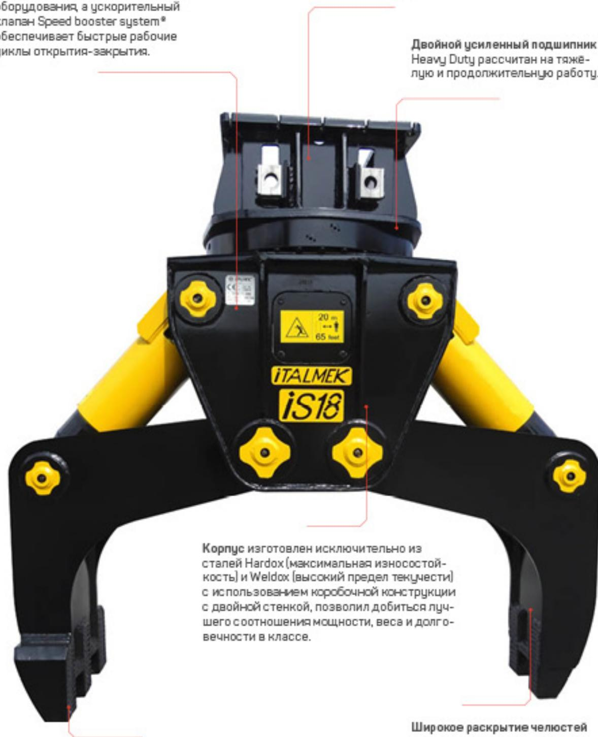
Корпус изготовлен исключительно из сталей Hardox (максимальная износостойкость) и Weldox (высокий предел текучести) с использованием коробчатой конструкции с двойной стенкой, позволил добиться лучшего соотношения мощности, веса и долговечности в классе.
