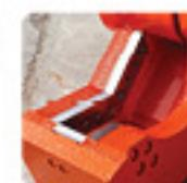
Используемые на четыре стороны ножи специальной закалки позволяют работать с нержавеющей сталью на постоянной основе и сохраняют точную линию отреза на протяжении длительного срока. Оптимально подобранная геометрия рабочих челюстей (6-го поколения гидравлических ножниц ITALMEK) обеспечивает оптимальный захват разрезаемого материала и перемещение его в зону максимального усилия реза и правильного распределения нагрузки.
