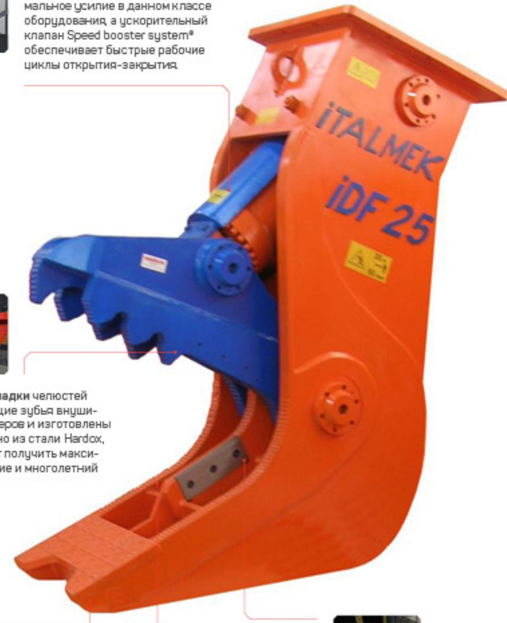
Корпус изготовлен исключительно из сталей Hardox (максимальная износостойкость) и Weldox (высокий предел текучести), что позволило добиться лучшего соотношения мощности, веса и долговечности в классе.
